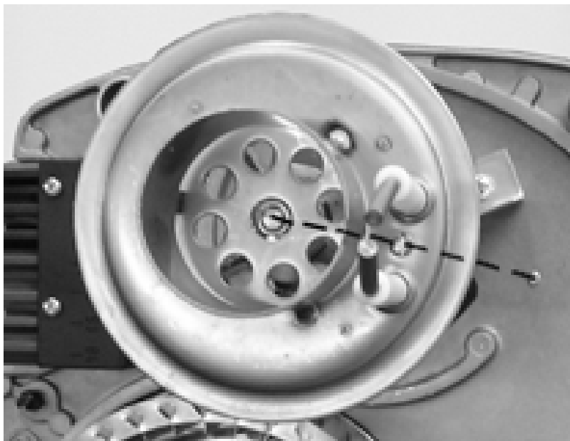
Abb. 43: Mischsystempositionierung und Ausrichtung Zünderode (Zünderodenabstand 2-3 mm)
