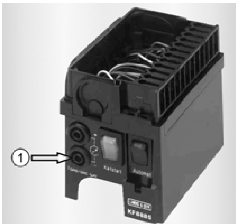
Abb. 38: Prüfsockel KF 8885 (Sach-Nr. 95.95215-0085)
