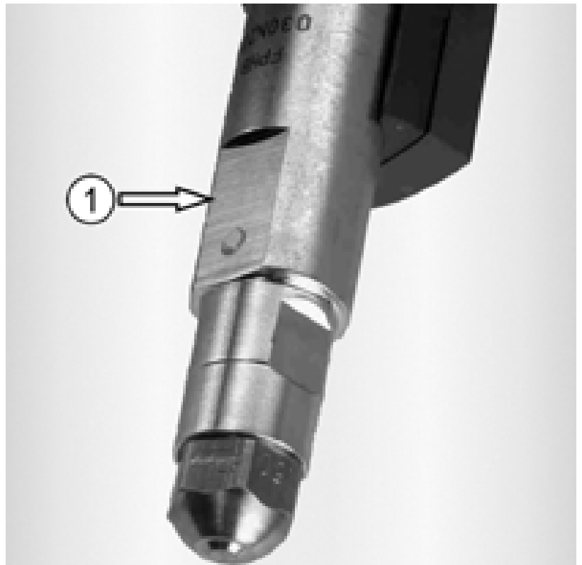
Abb. 41: Heizölvorwärmung mit Passfläche ① für Verdrehsicherung
